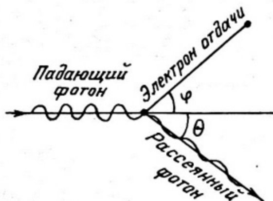
Рис. 4. Направления движения фотонов и электрона отдачи при комптоновском рассеянии
